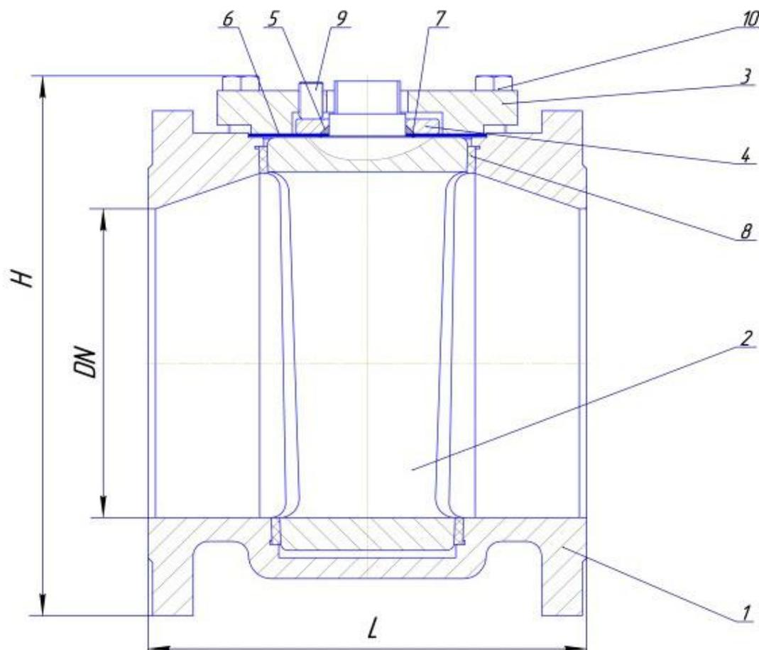
1 - корпус, 2 - пробка, 3 - крышка, 4 - кольцо нержавеющей, 5 - прокладка, 6 - прокладка нержавеющей, 7 - прокладка фторопластовая, 8 - втулка, 9 - винт, 10 - болт
