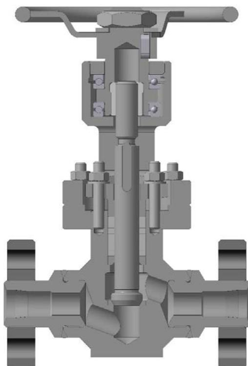
Клапан запорный проходной (прямоточный) предназначен для установки в системах трубопроводов высокого давления в качестве запорного устройства. Служит для перекрытия потока рабочей среды (жидкой или газообразной).
