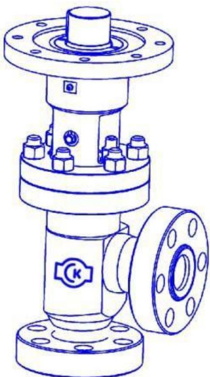
Клапан угловой предназначен для установки в системах трубопроводов высокого давления в качестве запорного устройства. Служит для перекрытия потока рабочей среды (жидкой или газообразной). Угловая конструкция призвана для экономии места, повышения надежности и увеличения срока работы на отказ.
