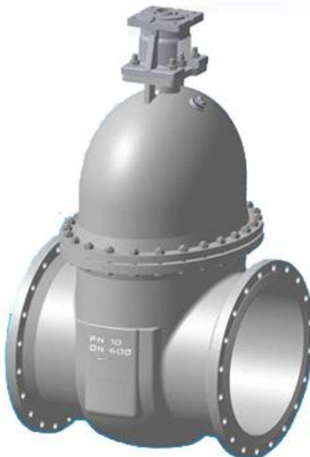
**Применяются** в качестве запорного устройства на трубопроводах, транспортирующих неабразивные жидкие и газообразные среды с температурой рабочей среды не более 300°C для стальных задвижек DN 50÷1600мм и не более 120°C для чугунных DN50 ÷ 2000мм , по отношению к которым применяемые в задвижках материалы имеют низкую скорость коррозии.
