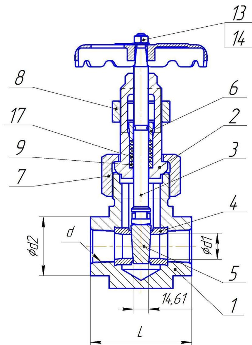
1 - корпус, 2 - крышка, 3 - шпindelь, 4 - седло, 5 - клин, 6 - грундбуksа, 7 - гайка корпуса, 8 - гайка крышки, 9 - кольцо, 10 - маховик, 13 - гайка, 14 - шайба, 17 - кольцо
